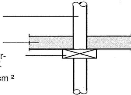
6.2 Schachtlösung für Lüftungsanlagen nach DIN 18017-3:1990-08
