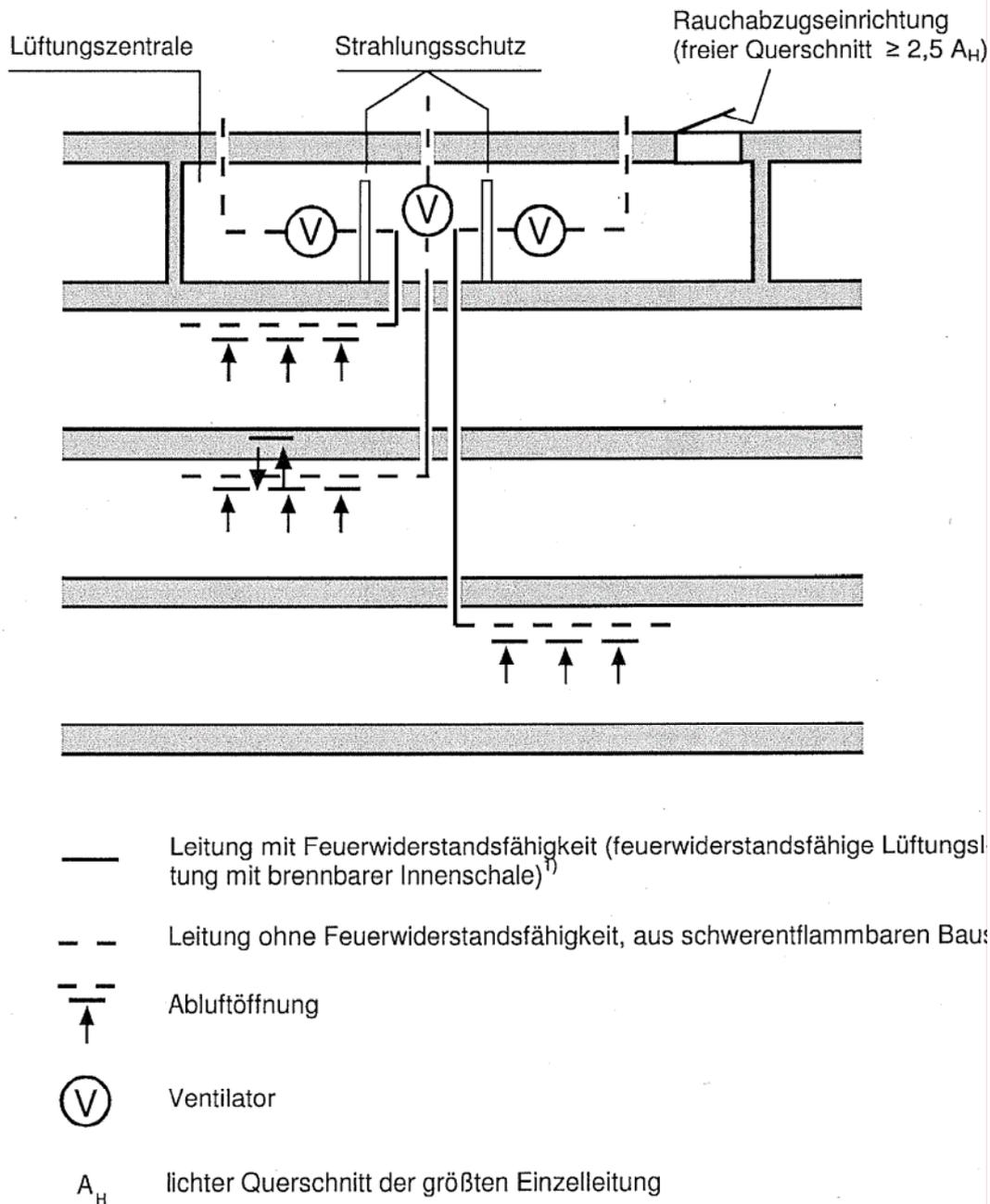
1) Die Feuerwiderstandsfähigkeit der Leitungen muss auch in den Durchdringungen der Decken oder Wände gegeben sein.
