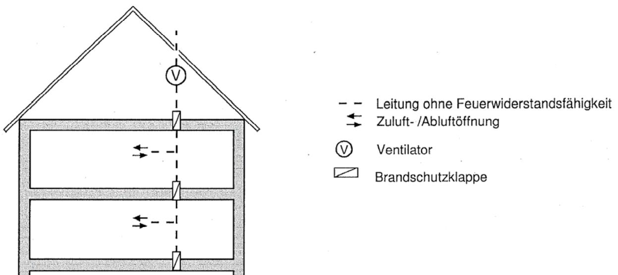
Bild 2.2: Schachtlösung
